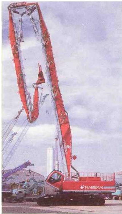
Slika 1. Najveći u svijetu bager s rukama - KOBELCO SK160033 (ruka dohvata 50,86 m).
