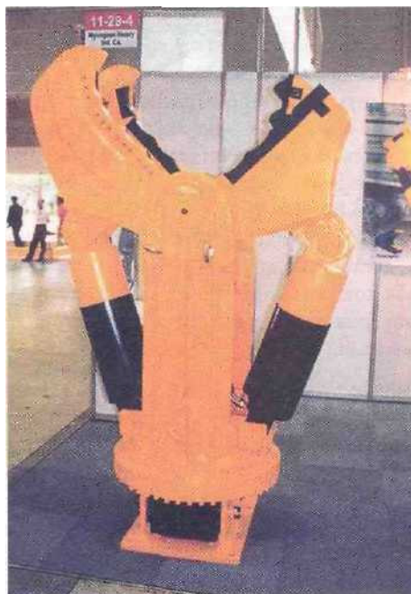
Slika 3 — Novi alati za rušenje s izmjenjivim čeljustima i dvostrukim cilindrima
